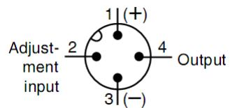
Схема подключения датчика:
